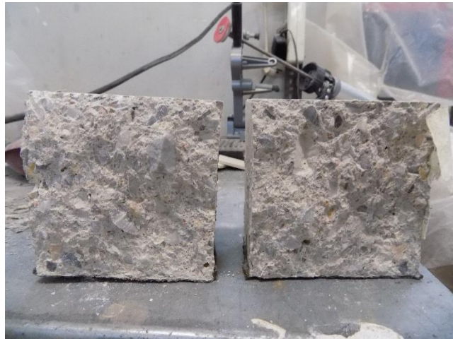
Φωτ.4 Διαρρηγμένο δοκίμιο όπου φαίνεται μηδενική διείσδυση νερού
