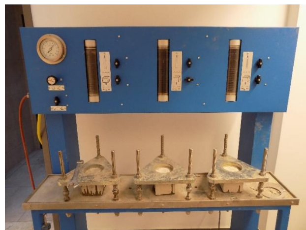
Φωτ.2 Διάταξη ελέγχου διείσδυσης νερού υπό πίεση
