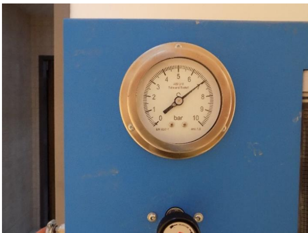
Φωτ.1 Πίεση νερού ίση με 7 bar
